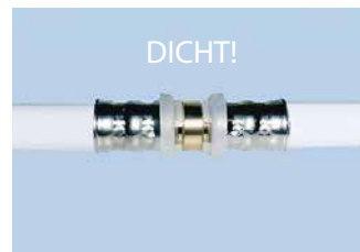
Zwischen 1 und 4,5 bar geprüfter, verpresster Fitting: DICHT.
