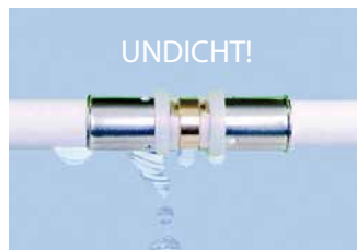
Zwischen 1 und 4,5 bar geprüfter, nicht verpresster Fitting: UNDICHT.
