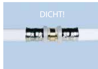
Zwischen 1 und 4,5 bar geprüfter, verpresster Fitting: DICHT.
